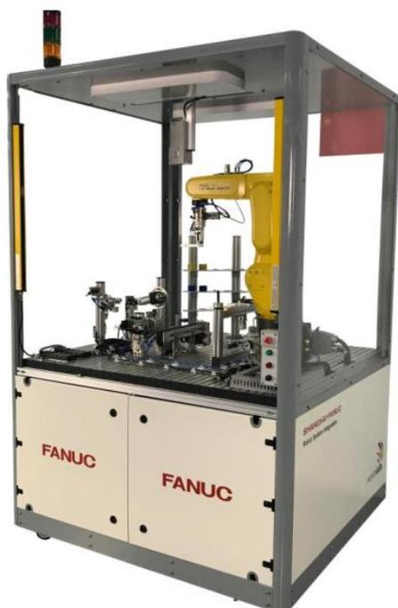
机器人系统集成项目设备由平台主体、多关节六自由度机器人模块、2D 视觉相机模块、竞赛任务基础组件、竞赛任务拓展组件和电脑桌、装配桌等辅助设备组成。平台采用 T 型槽的结构形式,方便各竞赛模块根据竞赛任务要求进行布局设计安装。
